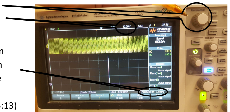
Figure 3 : on augmente la durée d'acquisition à T_a = 100.T càd un calibre base temps = 10 ms par carreau.
